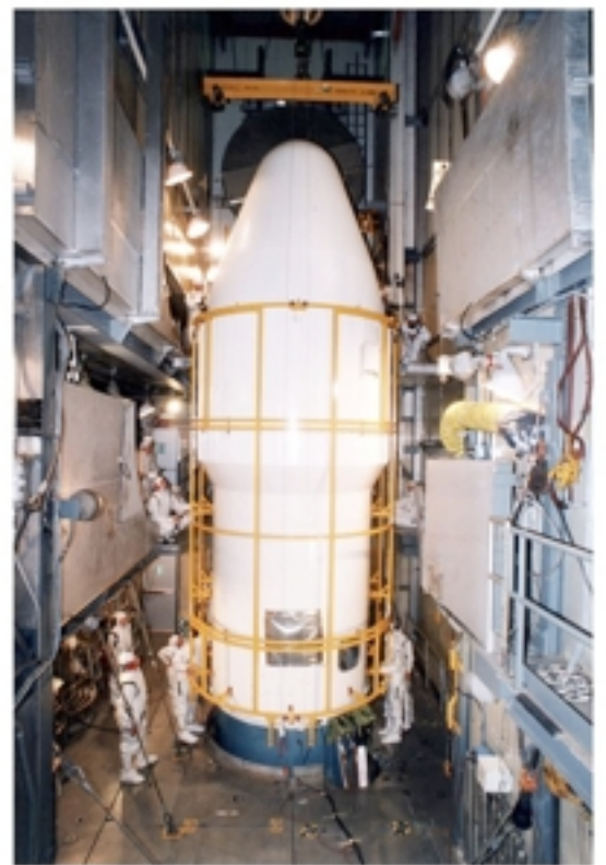
Mars Pathfinder mit oberster Raketenstufe wird in seine Startverkleidung eingebaut.
