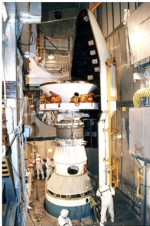
Mars Pathfinder mit oberster Raketenstufe wird in seine Startverkleidung eingebaut.
